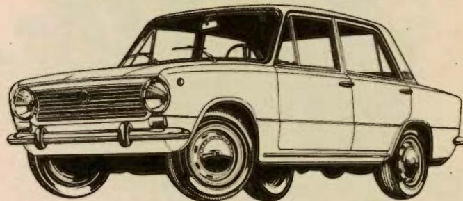
Con motor de 1.197 cm<sup>3</sup> y 65 CV-SAE. Un coche de potencia suficiente para responder en todo momento. Y seguro: el 124-D lleva doble circuito de frenos, además de los cuatro frenos de disco. Y neumáticos radiales.
